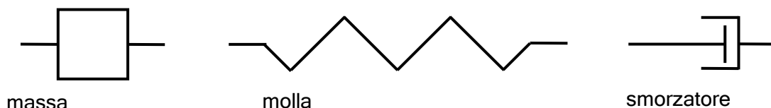
Figura 1-1. Elementi di base di un sistema vibrante.
