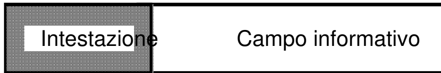
Fig. III.13 - Struttura generale di una trama in un protocollo orientato al bit.
