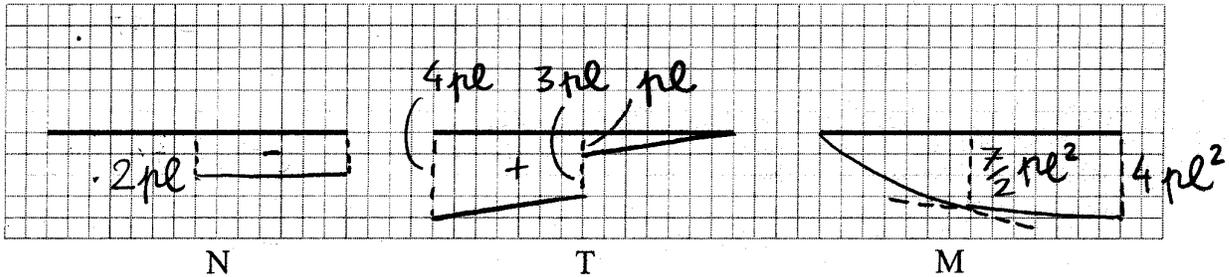
**Problema 2.** Si consideri il sistema in fig. 2. Si trascurino le deformazioni estensionali e di scorrimento. Tutti i tratti hanno la stessa rigidezza flessionale  $r_F$ , costante lungo l'asse.
