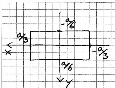
Sia ora la sezione sottoposta ad una forza normale eccentrica di compressione applicata nel punto di coordinate  $(x, y) = (\frac{a}{2}, \frac{a}{2})$ .
