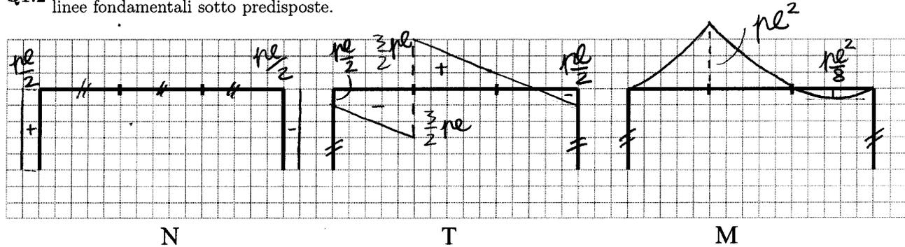
**Problema 2.** Si consideri il sistema in fig. 2. Si trascurino le deformazioni estensionali e di scorrimento. Tutti i tratti hanno la stessa rigidezza flessionale  $r_F$ , costante lungo l'asse.
