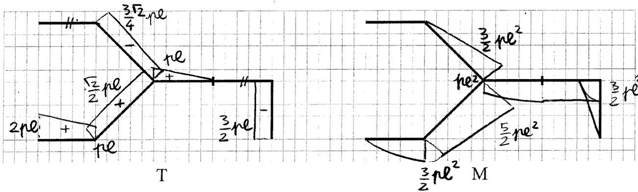
**Problema 2.** Si consideri il sistema in fig. 2(a). Si trascurino le deformazioni estensionali e di scorrimento. Tutti i tratti hanno la stessa rigidezza flessionale  $r_F$ , costante lungo l'asse.
