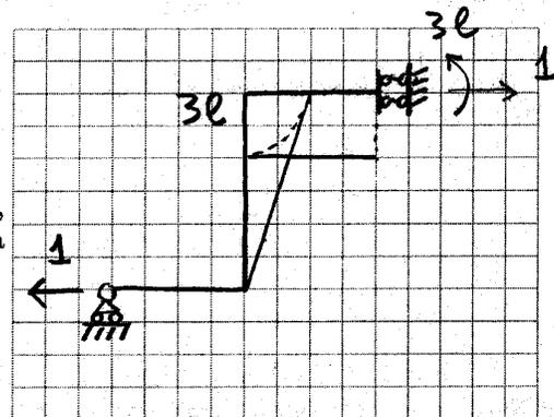
Q2.2 Calcolare il coefficiente di elasticità  $\eta_{11}$ .
