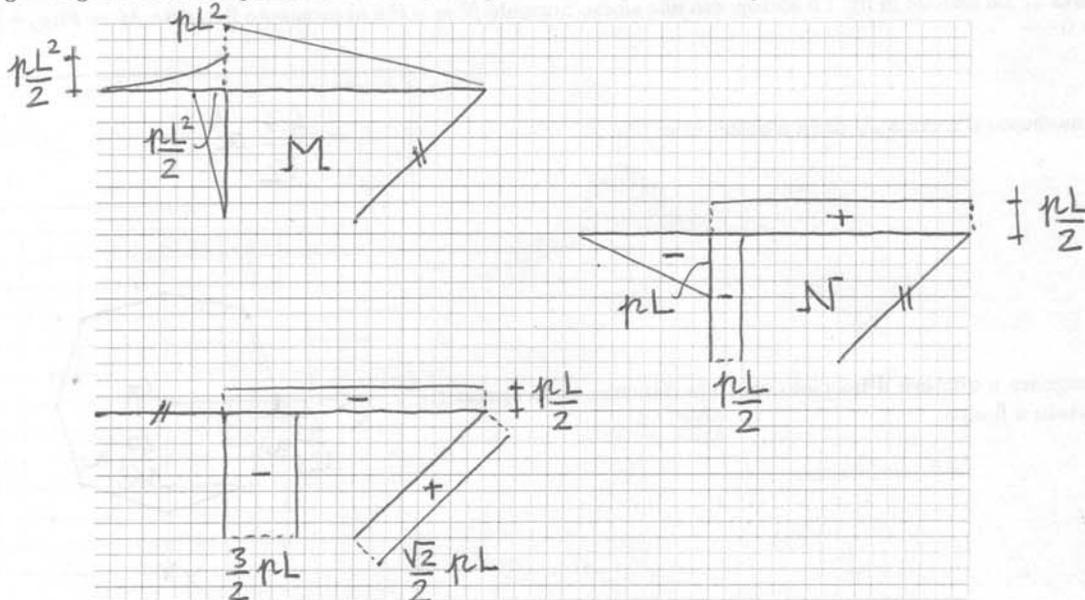
Q3.3 Tra le sezioni di controllo indicate in figura, elencare quelle più significative ai fini della verifica di resistenza della travatura.
