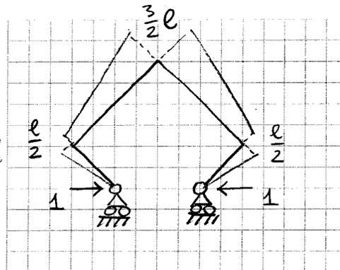
Q2.2 Calcolare il coefficiente di elasticità  $\eta_{11}$ .
