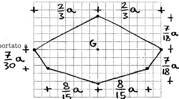
Sia la sezione sottoposta ad un momento flettente  $M = -M(e_x + e_y)$ , con  $M > 0$ .
