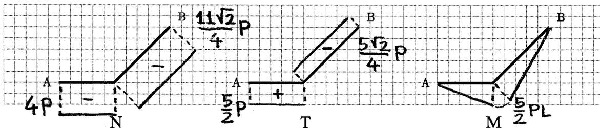
Q2.2 Calcolare l'abbassamento del punto B.
