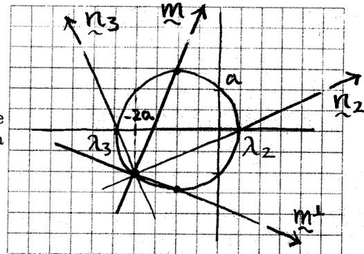
Q4.3 Sia  $\sigma_L$  la tensione limite del materiale. Trovare il massimo valore di  $a$  tale che la verifica di resistenza secondo Tresca sia soddisfatta.
