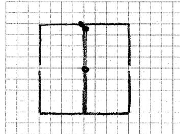
Q3.4 Sia  $\sigma_L$  la tensione limite del materiale. Determinare il minimo spessore  $\delta$  che la sezione deve avere per resistere alle sollecitazioni date secondo il criterio di Tresca.
