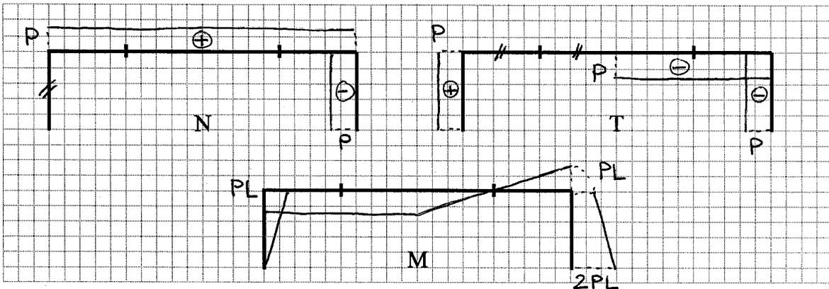
Si consideri ora la travatura in fig. 2(b), le cui proprietà deformative sono costanti lungo la linea d'asse. L'intera travatura è sottoposta ad una variazione di temperatura  $\Delta t > 0$  uniforme sulla sezione e costante lungo la linea d'asse.
