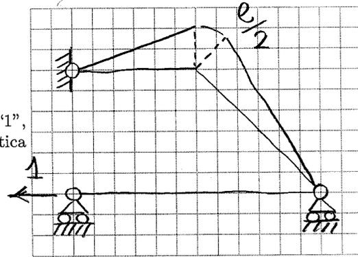
Q1.2 Calcolare il coefficiente di elasticità  $\eta_{11}$ .
