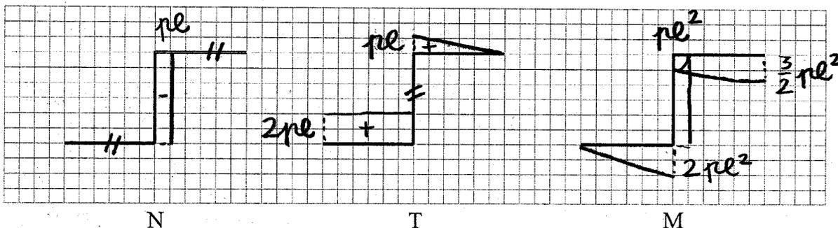
**Problema 3.** Si consideri la sezione sottile in fig. 3(I) sottoposta ad una sollecitazione di taglio  $T_y = \dot{P}$  e momento  $M_x = 4Pa$ .
