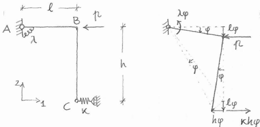
La struttura ruota intorno al punto A.
