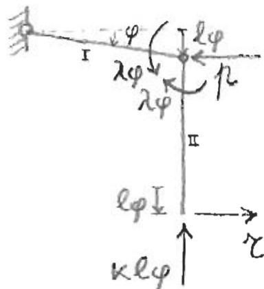
Il primo corpo ruota intorno ad A di un angolo  $\varphi$ .
